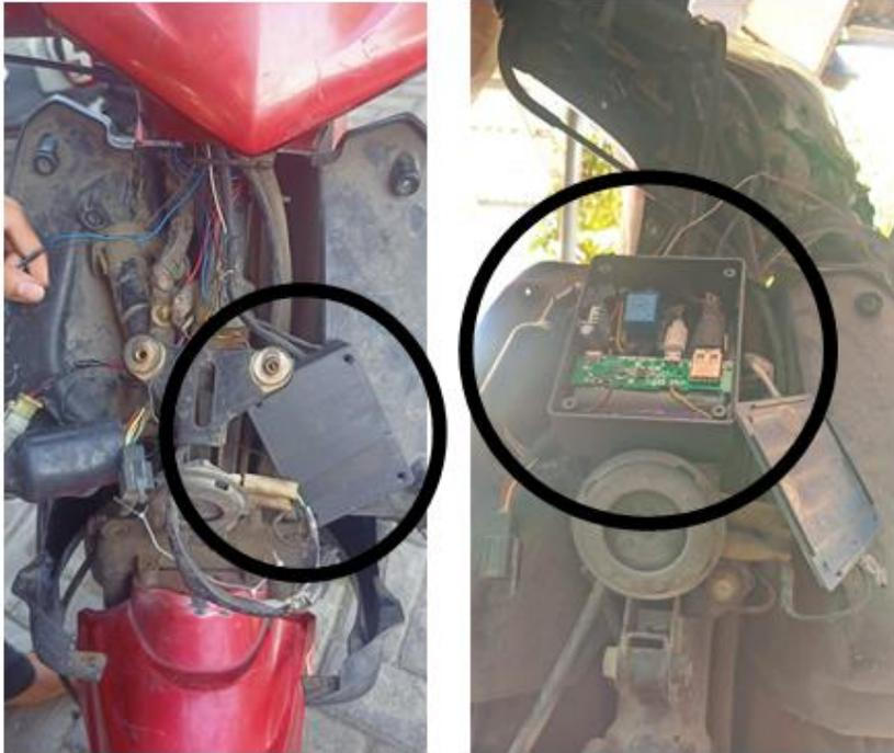
Box 1 ini terletak pada body bagian depan motor atau didalam cover body depan motor. Box 1 berfungsi sebagai sumber tegangan untuk menghidupkan ESP 32 Cam dan penyalur arus dari Aki ke alat pengaman motor.
