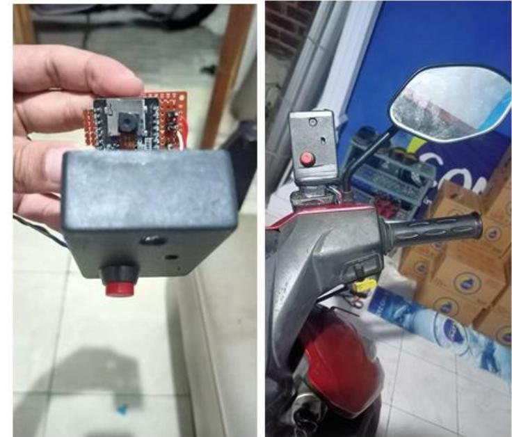
Box 2 terletak dibagian setir motor atau tempat yang mengarah secara langsung ke wajah pengendara motor. Pemasangan box 2 ini dapat menggunakan holder hp yang direkatkan pada spion, atau bisa menggunakan perekat seperti lem atau alat lainnya. didalam box 2 terdapat komponen utama yaitu ESP 32 Cam sebagai *face recognition* proses pengenalan wajah yang menentukan apakah motor dapat digunakan atau tidak
