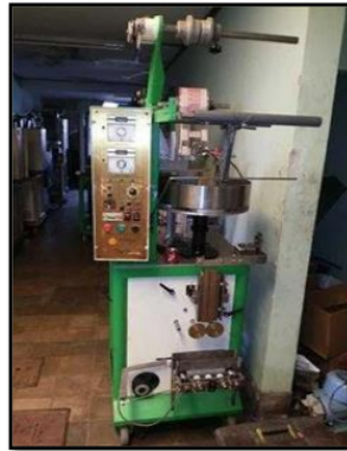
Gambar 5. Mesin Pengemasan Tempe Dengan 2 Penggerak Motor dan 2 elemen pemanas plastik
