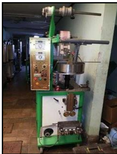
Gambar 5. Mesin Pengemasan Tempe Dengan 2 Penggerak Motor dan 2 elemen pemanas plastik
