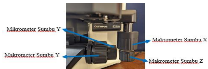
Gambar 18. Setting Fokus Pada Spesimen Uji.
