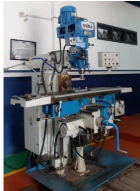
Gambar 1. Mesin Millng / Freis universal X6322C WEIDA.
