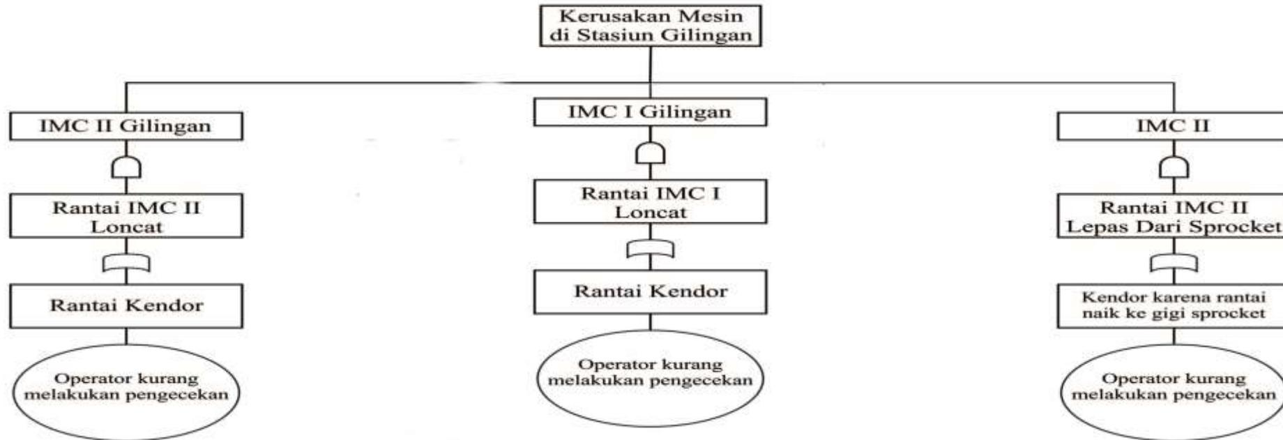
Diketahui bahwa kerusakan pada komponen IMC II Gilingan permasalahannya rantai IMC II Loncat disebabkan karena rantai kendor karena operator tidak melakukan pengecekan, IMC II disebabkan karena rantai IMC II lepas dari Sprocket karena operator kurang melakukan pengecekan, IMC I Gilingan permasalahannya rantai loncat disebabkan rantai kendor karena operator kurang melakukan pengecekan.
