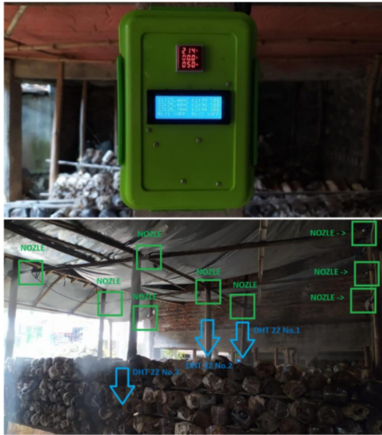
Gambar 4. Tampilan Alat, Sensor DHT22 dan Nozle Sprayer
