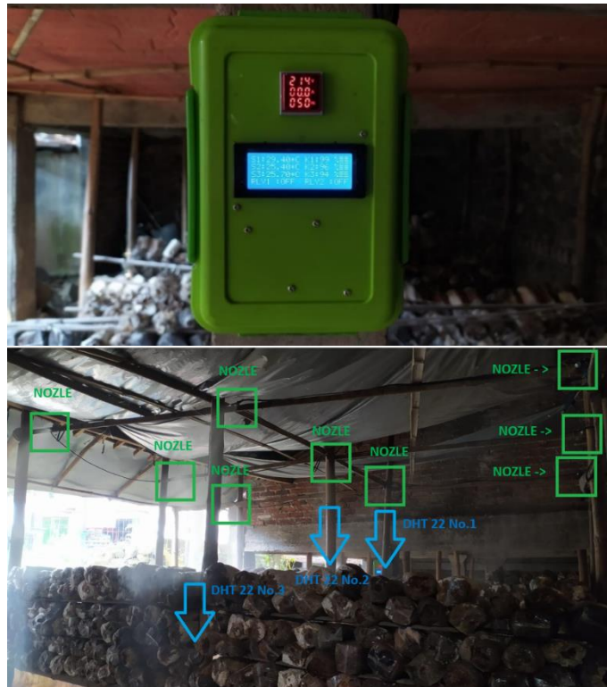
Gambar 4. Tampilan Alat, Sensor DHT22 dan Nozle Sprayer
