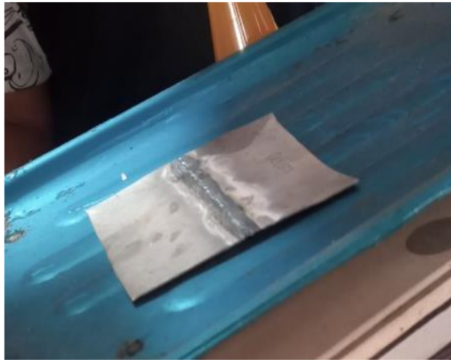
Gmabar 1. Plat galvanis uji korosi
