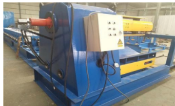
Gambar 3. Mesin Decoiler Sumber: PT. Bumi Lestari Karya Perkasa
