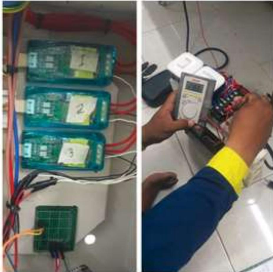
Pengujian ini perlu untuk dilakukan perihal untuk mengetahui sensor PZEM004T apakah dapat terbaca setelah di gabungkan dengan microcontroller ESP8266 melalui komunikasi UART dengan membandingkan keakuratan sensor PZEM004T dengan avometer.
