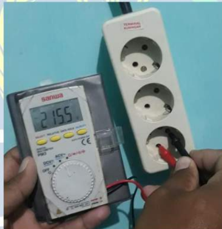
Gambar 4. 18 Colokan Kedua Probe Pada Stop Kontak
