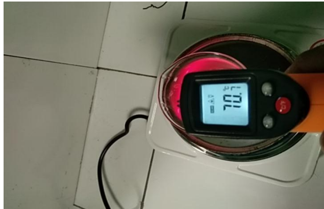
Gambar 3. Pengecekan suhu panas campuran komposit
