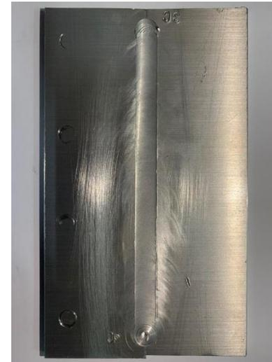
Gambar Pengelasan FSW
