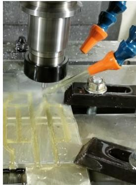
Gambar Pemotongan Spesimen
