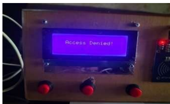
Gambar 7. Tampilan LCD I2C Pada Kartu RFID yang Belum Terdaftar
