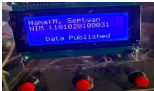
Gambar 6. Tampilan LCD I2C Pada Kartu RFID yang Terdaftar
