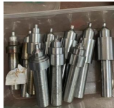
Gambar 3. Hasil Pembuatan Tool FSW Geometri Hexagonal
