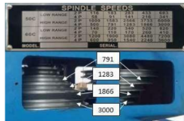
Gambar 7. Setting Kecepatan Putaran Spindle
