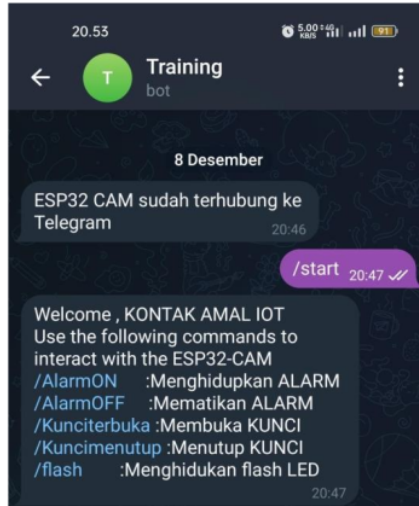
Gambar 4.6 Pengujian Menghidupkan dan mematikan Alarm
