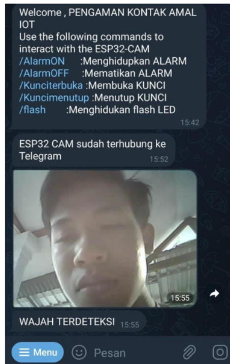
Gambar 4.5 Pengujian Koneksi ESP32 -CAM
