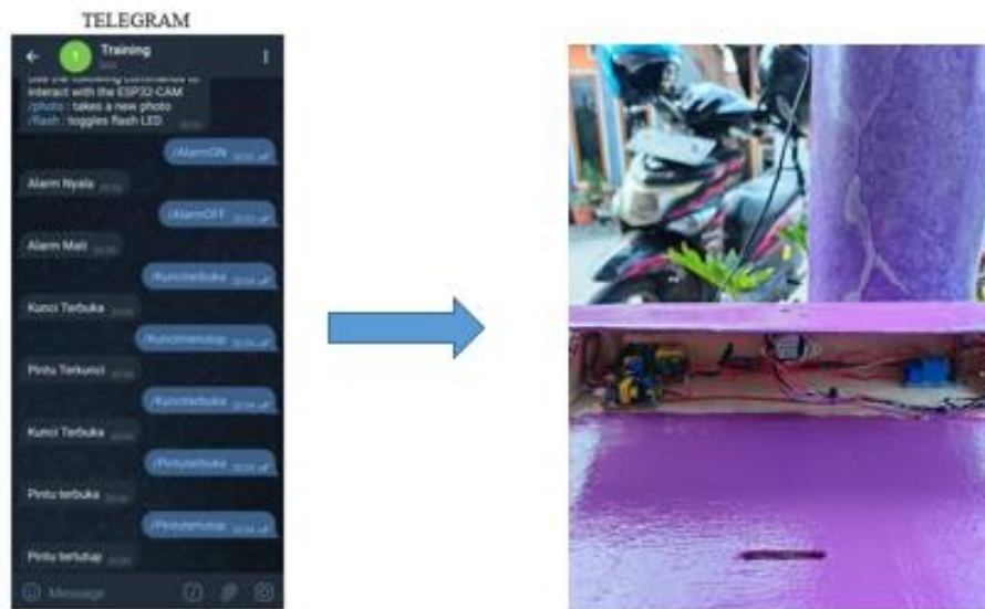
Gambar 5 Pengujian perintah chatbot ke input dan output alat
