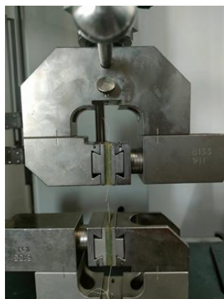
Gambar 1. Hasil Patahan Uji Tarik Serat
