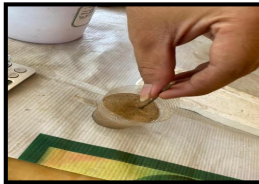
5. Proses Pencampuran Serat Sansivera Dengan EPOXY
