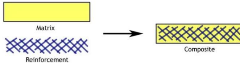
Gambar 1. Struktur Material Komposit
