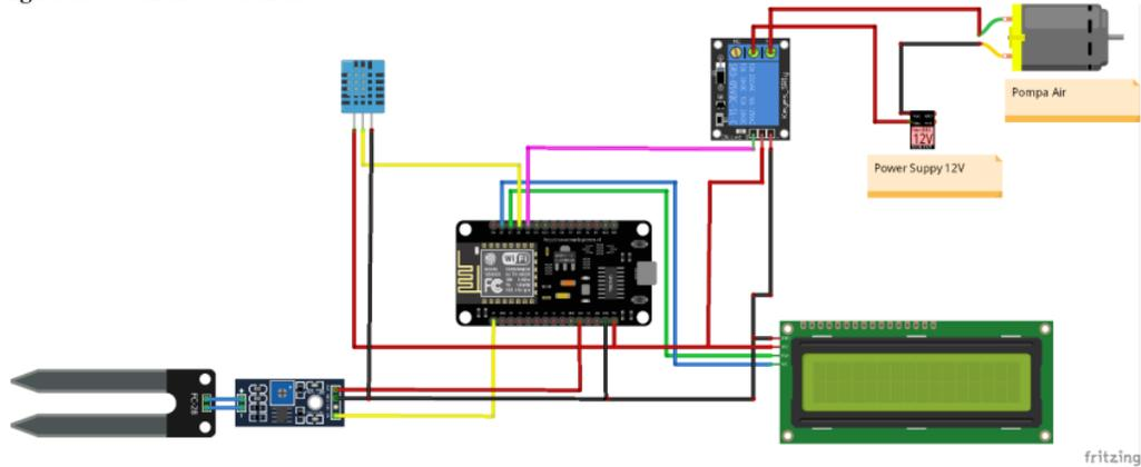
Gambar 6. Rangkaian Sistem Keseluruhan
