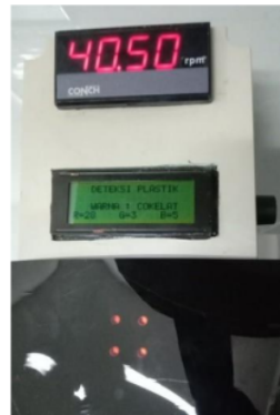
Gambar 6 Pembacaan RGB Warna Plastik Yang Setelah Motor Bekerja
