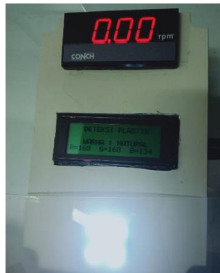
Gambar 5 Pembacaan RGB Warna Plastik Yang Masih Berwarna Natural
