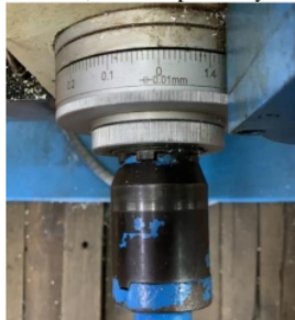
Gambar 12. Setting Kedalaman Pengelasan
