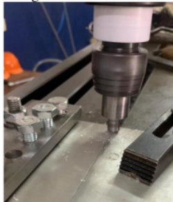
Gambar 13. Posisi Shoulder Mendekati Spesimen
