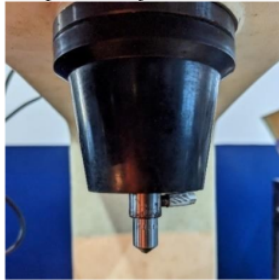
Gambar 22. Pemasangan Indentor Pada Alat Uji
