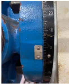
Gambar 11. Posisi Setting Kemiringan Mesin
