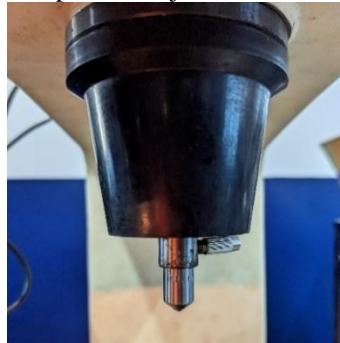
Gambar 22. Pemasangan Indentor Pada Alat Uji
