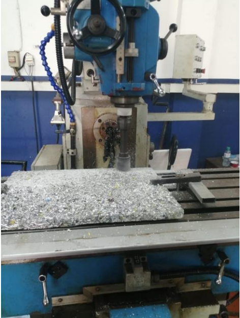
Meratakan permukaan meja dengan mesin fraise
