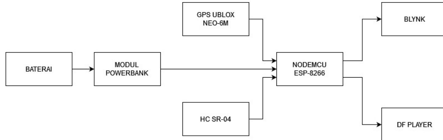
Tongkat pintar menggunakan baterai yang terhubung dengan modul *powerbank* sebagai sumber daya dari mikrokontroler NodeMCU ESP-8266, kemudian GPS U-blox NEO-6M berfungsi sebagai *GPS Tracker* dan sensor ultrasonik (HCSR-04) sebagai pendekripsi halangan dari tongkat. Output yang dihasilkan adalah bunyi dari DF Player ketika terdapat halangan di sekitar, serta Blynk sebagai *monitoring* koordinat pengguna yang dapat dipantau secara *real-time* melalui *smartphone*.
