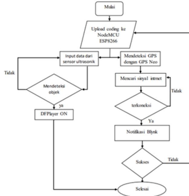
Mula-mula, pengguna menekan switch ON pada alat, lalu program yang ada pada mikrokontroler NodeMCU ESP-8266 akan bekerja setelah menerima input data dari sensor ultrasonik, dimana **ketika sensor mendeteksi objek**, maka DF Player akan mengeluarkan **suara**. Jika sensor tidak mendeteksi apapun, DF Player akan **diam**.
