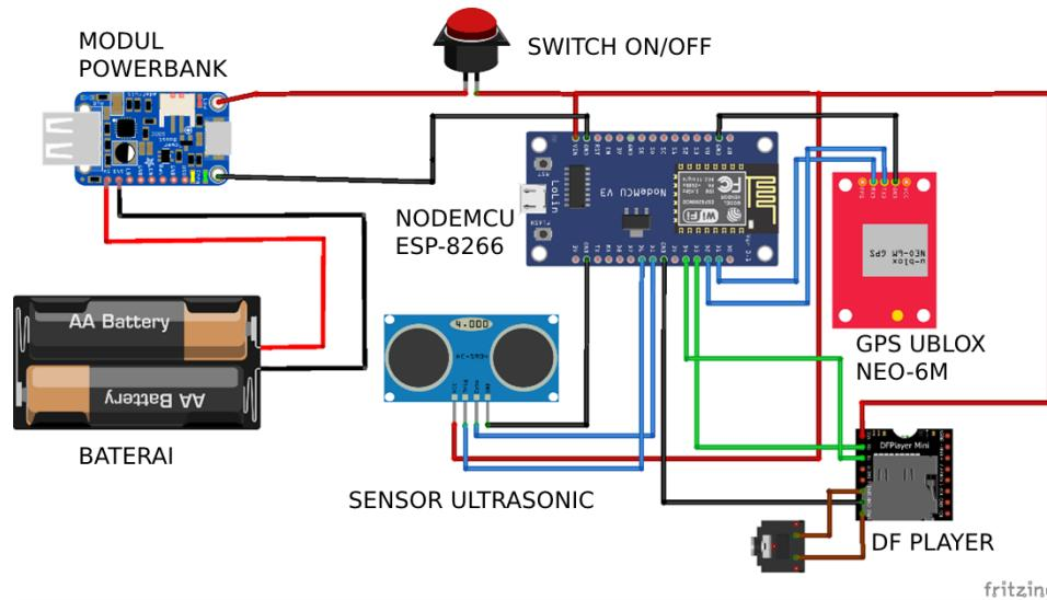
GPS U-blox Neo-6M yang dihubungkan pada mikrokontroller NodeMCU dengan menggunakan port pin D2 untuk TX dan pin D1 untuk RX dari GPS. Untuk tegangan pada pin VCC akan masuk pada pin 3,3 V dari mikrokontroler NodeMCU. Sensor ultrasonik menggunakan pin D5 untuk pin echo dan pin D6 untuk pin trigger. Kemudian, DF Player memanfaatkan pin D3 sebagai RX dan pin D4 sebagai TX.
