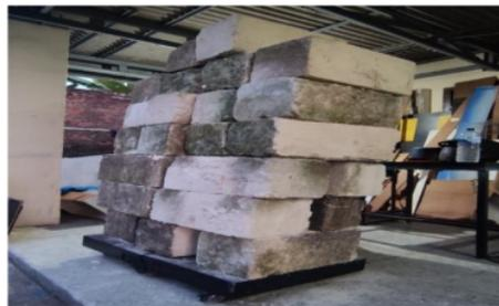
**Gambar 3.14** troli dengan uji beban tekan tinggi 875kg
