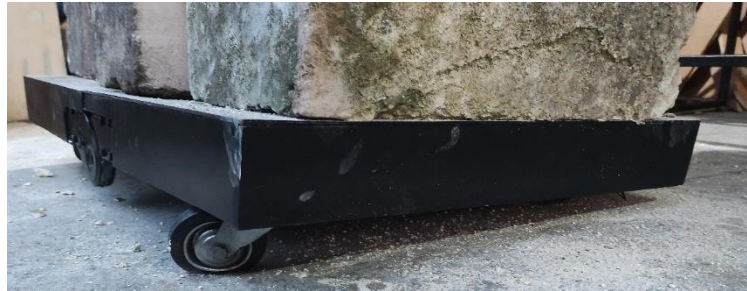
Gambar 3.15 keadaan troli uji beban tekan tinggi 875kg
