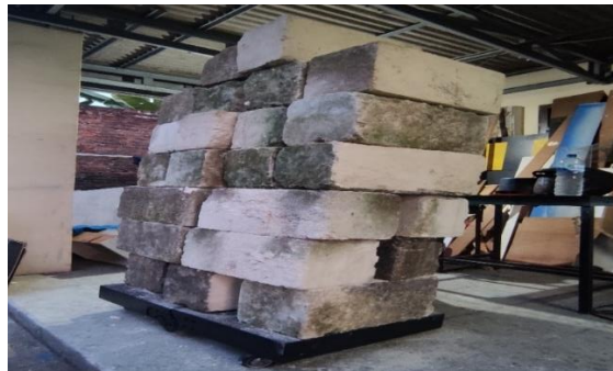
Gambar 3.14 troli dengan uji beban tekan tinggi 875kg
