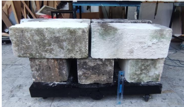
Gambar 3.12 troli dengan uji beban tekan 245kg
