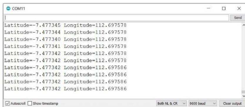
Gambar 15. Hasil pembacaan modul GPS
