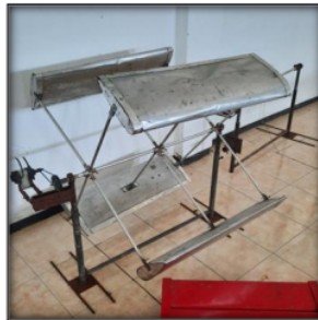
Gambar 4. Alat Wind Turbin Menggunakan Blade NACA 0021
