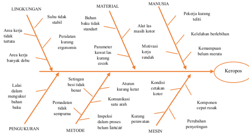
Gambar 8. Diagram Sebab Akibat (Diagram Fishbone ) pada Jenis Cacat Keropos
