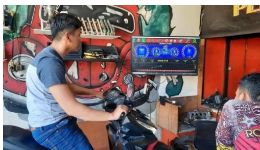
Gambar 2. Pengujian Roller Standart Dan Roller Variasi Dengan Dynotest
