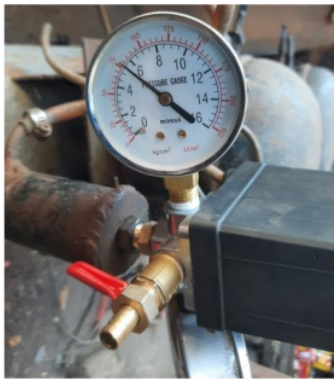
Gambar 2. Hasil uji tekanan kompresor modifikasi
