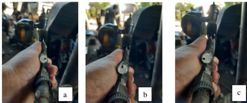
Gambar 3. a. Setelan nozzle buka \frac{1}{4} , b. Setelan nozzle \frac{1}{2} , c. Setelan nozzle \frac{3}{4}
