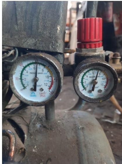
Gambar 3. Hasil uji tekanan kompresor konvensional
