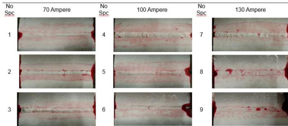
**Gambar 1.2** Hasil Pengelasan dan Liquid Penetrant Testing
