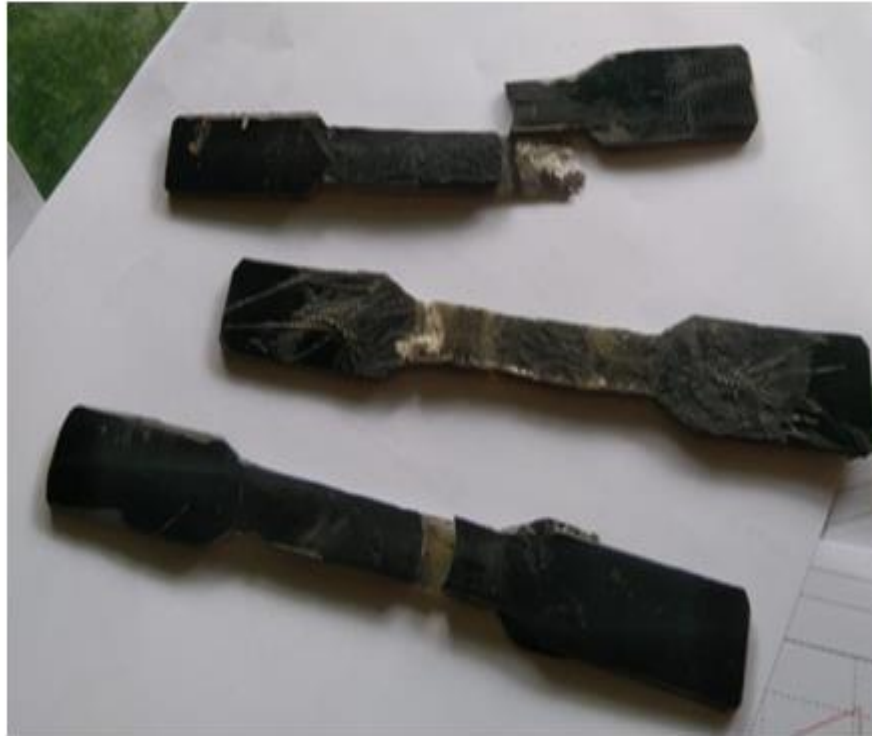
Gambar 4.21 Body Supra setelah uji tarik
