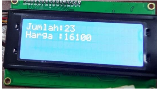
Gambar 4. Tampilan LCD I2C 20x4 Saat Alat Bekerja
