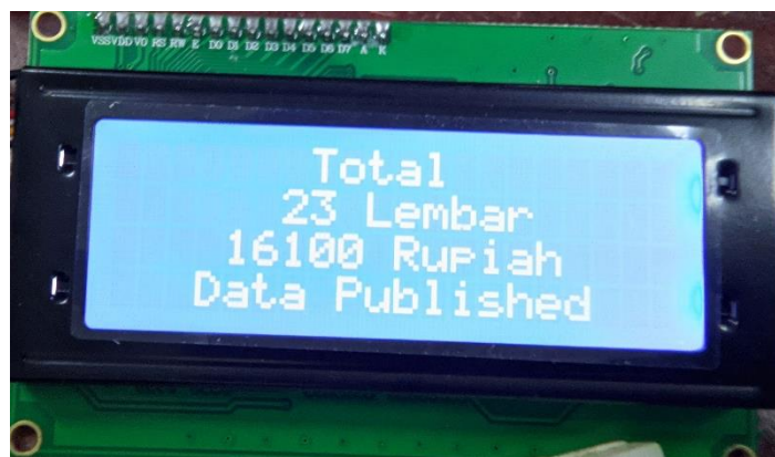
Gambar 5. Tampilan LCD Setelah Push Button Ditekan dan Mengirimkan Data ke Google Sheets
