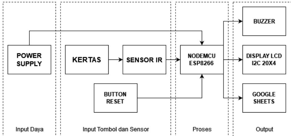
Power supply bertindak sebagai input daya dan kertas hasil *print* sebagai input objek yang dideteksi sensor IR, dan *push button* sebagai tombol reset harga dan pengiriman data melalui jaringan internet. NodeMCU ESP8266 berfungsi sebagai pemroses logika pada program yang telah dibuat. Setelahnya, terdapat tiga output berupa *buzzer* sebagai indikator saat sensor IR aktif, LCD I2C 20x4 sebagai penampil harga ke pelanggan, dan *Google Sheets* sebagai lokasi rekap pendapatan.
