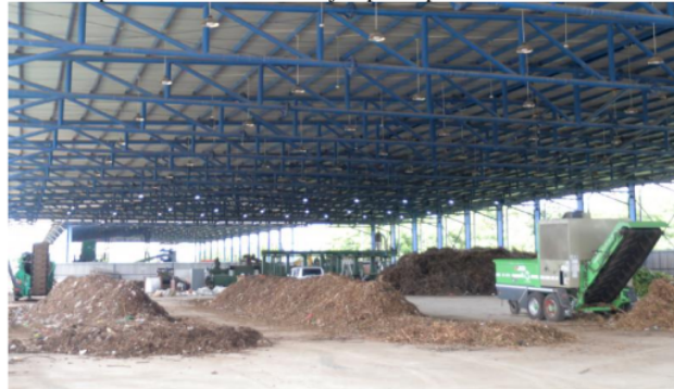
Gambar 4. Proses pembuatan bahan bakar jumputan padat atau refuse-derived fuel (RDF)
