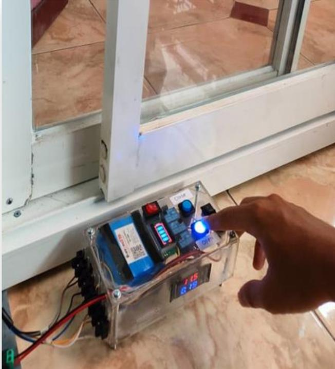
Pengujian Switch Manual Open
