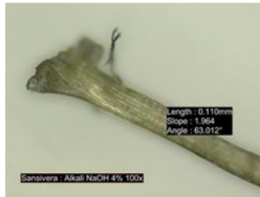
Gambar 8. Serat dengan perlakuan alkali NaOH 4%
