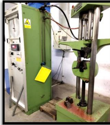
Gambar 6. mesin uji tarik komposit
