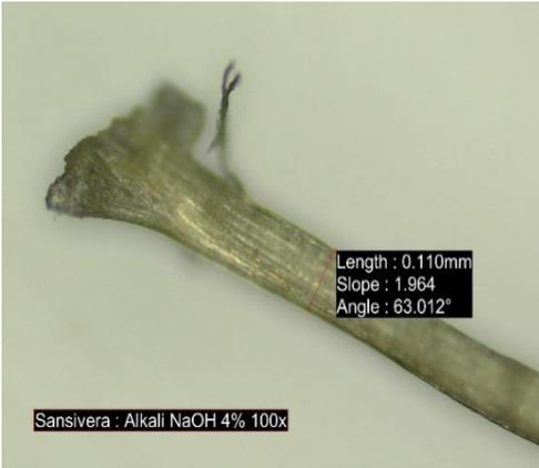
Serat tanpa perlakuan alkali NaOH Foto partikel serat yang diukur dengan magnitude 100x adalah 0,11 Mikrometer
