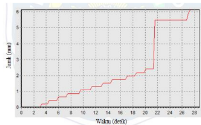
Gambar 9. Grafik Jarak Terhadap Waktu Spesimen 3 Suhu Preheating 80°C
