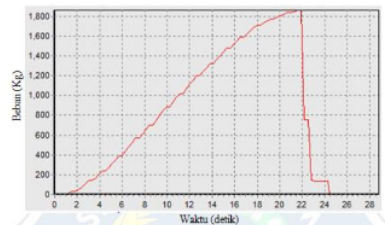
Gambar 8. Grafik Beban Terhadap Waktu Spesimen 3 Suhu Preheating 80°C
