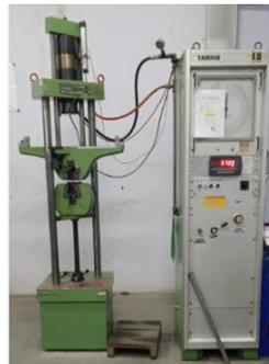
Gambar 1. Mesin Uji Tarik
