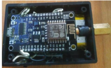
(Gambar 1 Tampak Dalam Alat Monitoring Tekanan Ban Kendaraan Berbasis IOT)
