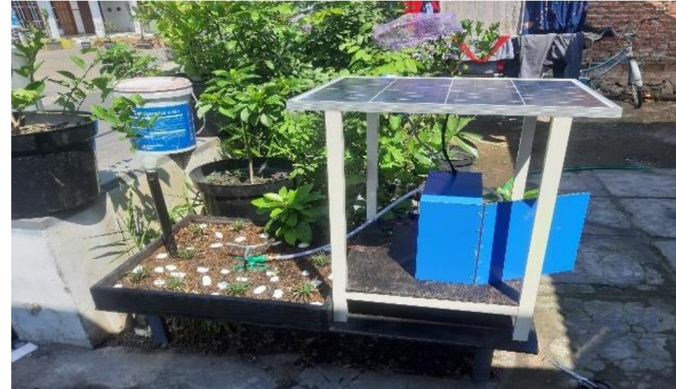
Pada foto gambar tampak samping terlihat solar panel , lampu taman, boc controller dan bagian taman. Terdapat sensor kelembapan tanah yang di tanam didalam tanah sehingga dapat mendeteksi kelembaban tanah secara optimal. Terdapat juga selang air yang berasal dari pompa air yang digunakan untuk menyiram taman. Pada bagian depan terdapat foto box kontrol yang terletak dibawah panel surya, dimana panel surya dapat digunakan sebagai atap pelindung dari box kontrol
