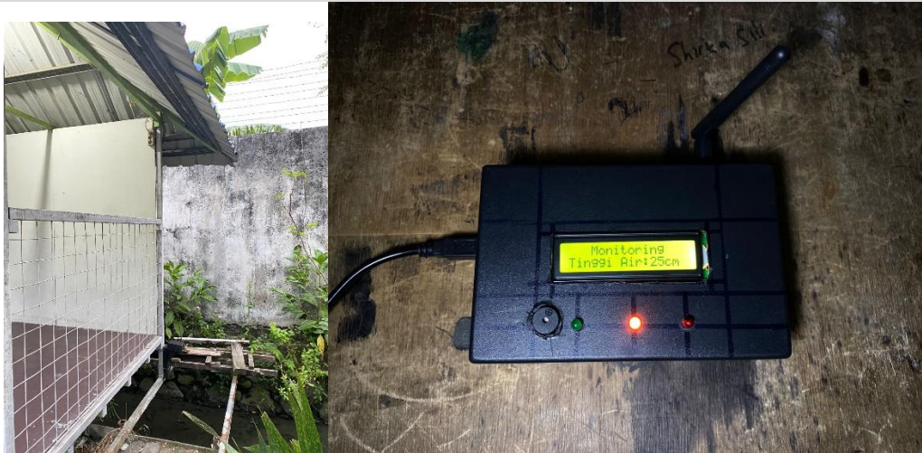
Gambar 11. Menampilkan kondisi siaga karena ketinggian air 25 cm
