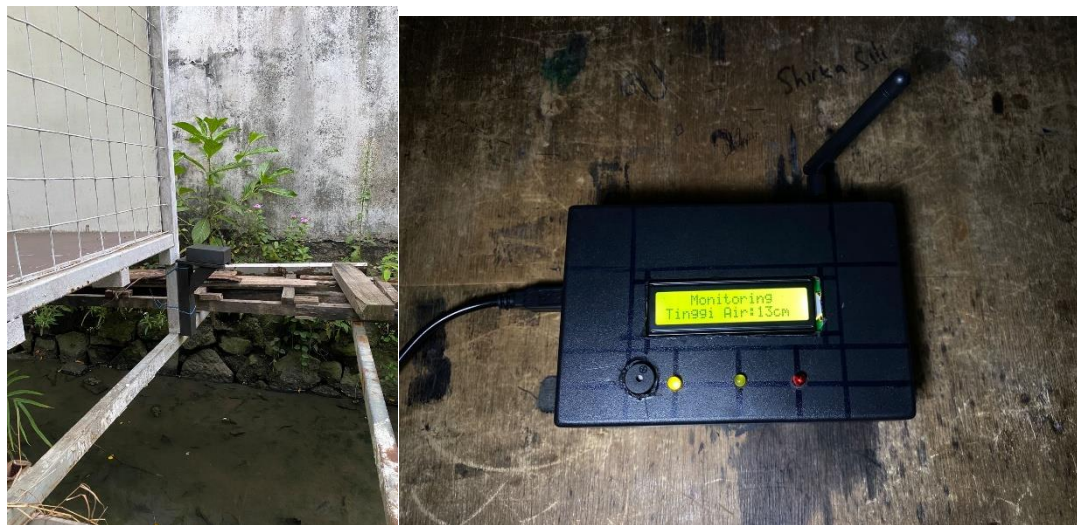
Gambar 10. Menampilkan kondisi aman karena ketinggian air < 25 cm
