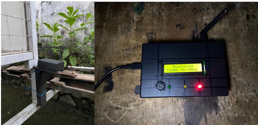
Gambar 12. Menampilkan kondisi awas karena ketinggian air > 45 cm
