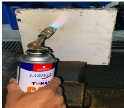
Gambar 12. Plat ACP di uji ketahanan api
